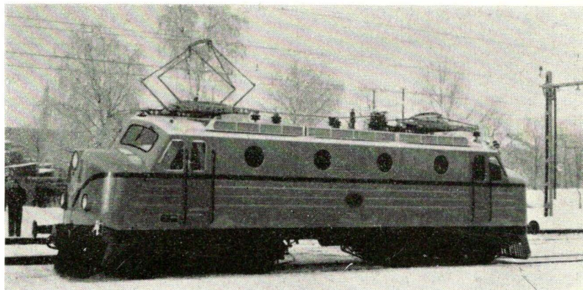
Rapid-lokomotivet, som leveres til SJ. Dette elektriske lokomotiv, hvoraf to prøve-lokomotiver er i drift, bygges til en maksimalhastighed af 150 km/h.
